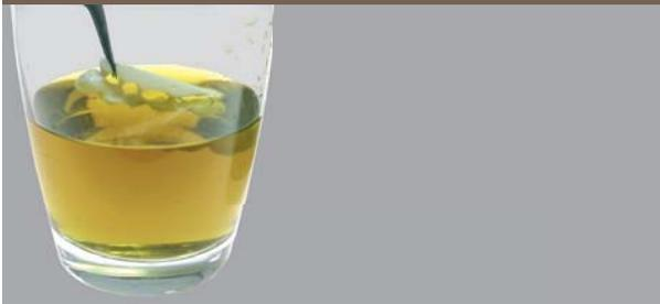
Processus de trempage – tremper env. 5 sec. dans le liquide de coloration
