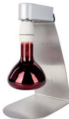
Laisser sécher les objets sous la lampe de séchage, directement sous l'ampoule. Fritter durant la nuit – temps de frittage env. 8 heures.
