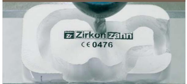
Fraisage d'ébauche de la forme extérieure avec la fraise 4L
